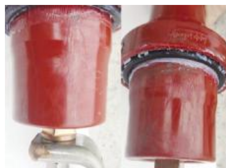
图 6 发生闪络击穿后的套管照片
