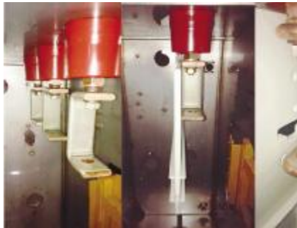
图 10 套管局部绝缘配合试验照片
